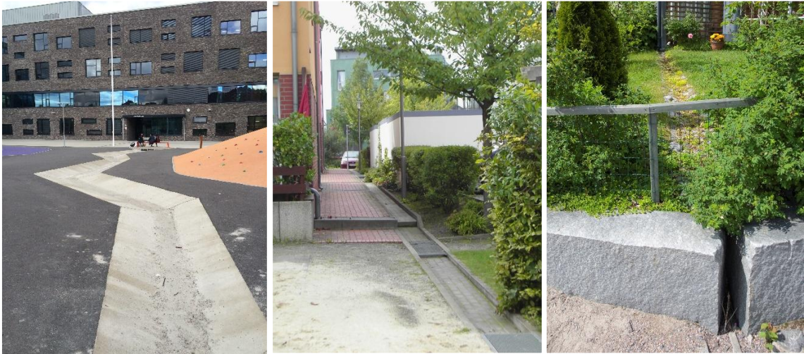
Kuvat 8-10. Hulevesien pintajohtaminen.
