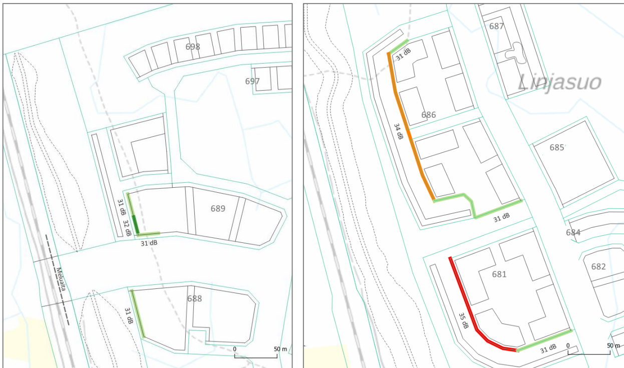
Kuva 3. Ulkovaipan äänitasoerotarve hetkellisten enimmäisäänitasojen perusteella meluntorjunta toteutettuna.
