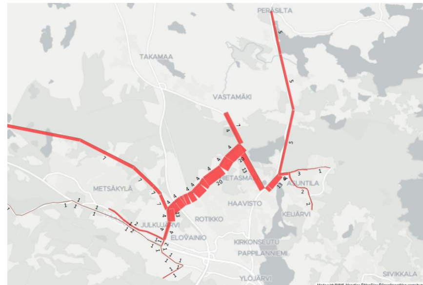
Siltatien läpikulkeva liikenne (ajon./h) vuoden 2040 ennustetilanteessa iltahuipputunnin aikana valtatie 3 uuden linjauksen kanssa
